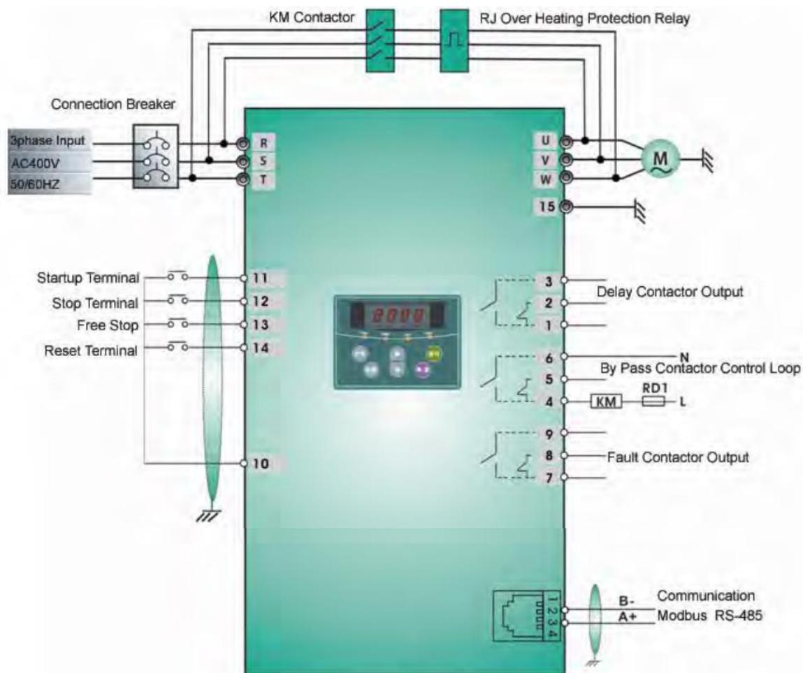
R, S, T – входы УПП; U, V, W - выходы. QF – автоматический выключатель, KM – контактор, RJ – тепловое реле, RD1 – плавкий предохранитель, L11 – N подключение 220В.
