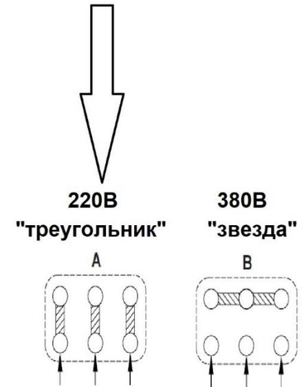
Схема подключения обмоток электродвигателя
